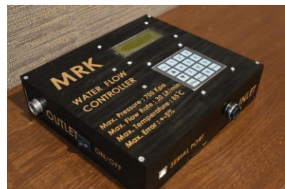
شکل ۲: کنترل کننده دبی حجمی ساخته شده
