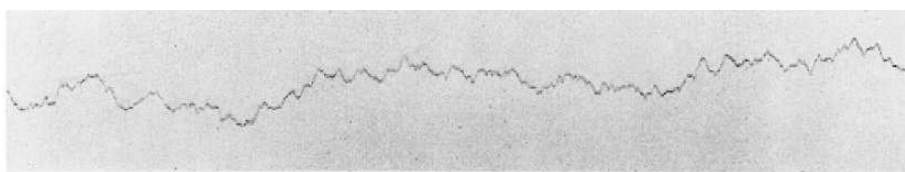
Registrieraufnahme der Brownschen Bewegung (natürliche Größe). Direktionskraft 9,428 \cdot 10^{-8} abs. Einh. Trägheitsmoment 1 \cdot 10^{-7} abs. Einh. Abstand Spiegel-Kamera: 72,1 cm. Zeitmarke: 30 sec dx = 1 mm. a) Atmosphärendruck. Temperatur 13^{\circ} C
